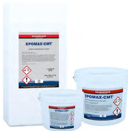
Mortero epoxi tixotrópico de 3 componentes, sin disolvente, para paredes y suelos. Para reparar, nivelar y alisar paredes y suelos a base cementicia que vayan a ser cubiertas con revestimientos epoxi, poliuretano, etc. También apto para su uso como revestimiento final en los casos en que se requiera alta resistencia a cargas mecánicas o a entornos corrosivos.
