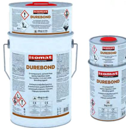
Resina epóxica de 2 componentes para unir concreto fresco a concreto endurecido. Se utiliza para puente de adherencia estructural, inyección y reparación de fisuras en concreto mayores a 3mm de espesor y para aplicaciones de anclaje horizontal, incluida la fijación de varillas de acero, en elementos de concreto, puede ser aplicado sobre sustratos húmedos. 2:1 (A+B).
