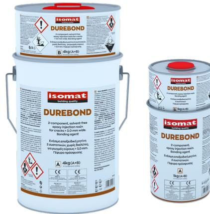
Resina epoxica de 2 componentes para unir concreto fresco a concreto endurecido. Se utiliza para puente de adherencia estructural, inyección y reparación de fisuras en concreto mayores a 3mm de espesor y para aplicaciones de anclaje horizontal, incluida la fijación de varillas de acero, en elementos de concreto, puede ser aplicado sobre sustratos húmedos. 2:1 (A+B).
